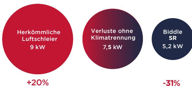
Ein Vergleich des Energieverbrauchs der Bankfiliale mit und ohne SR Luftschleier/Klimatrepper zeigt deutliche Energieeinsparungen von bis zu 29%. Mit einem herkömmlichen Luftschleier würde der Energieverbrauch dagegen um mehr als 20% ansteigen. Bezogen auf die Zeit, über die die Türen der Bankfiliale offen stehen (20%), beträgt die Energieeinsparung, die in der gesamten Lobby (30 m<sup>2</sup>) erzielt wird, durchschnittlich 34%.
